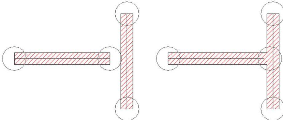
Για να εμφανίσετε ή να κρύψετε τον άξονα και τα πεδία δράσης του αυτόματου καθαρισμού που υπάρχουν σε κάθε τοίχο, μπορείτε να επιλέξετε έναν από τους τοίχους στο σχέδιο και να πατήσετε το δεξιό πλήκτρο του ποντικιού. Από το πτυσσόμενο μενού επιλέξτε: **Toggle Wall Graph Display** (Εναλλαγή εμφάνισης γραφήματος τοίχου).
